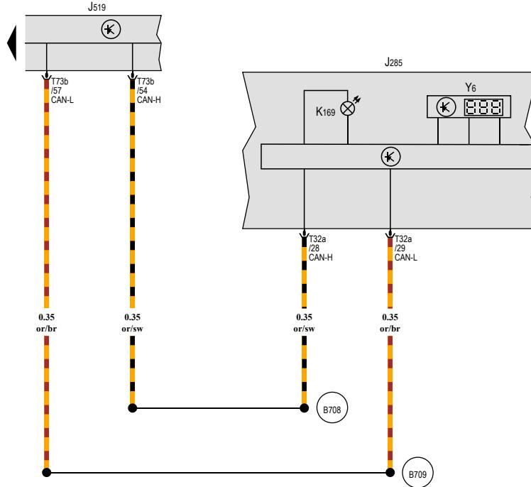
仪表板中的控制单元, 车载电网控制单元, 选档杆指示灯, 选档杆位置显示
