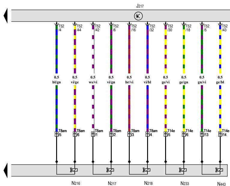
自动变速箱控制单元, 自动变速箱压力调节阀 2, 自动变速箱压力调节阀 3, 自动变速箱压力调节阀 4, 自动变速箱压力调节阀 5, 自动变速箱压力调节阀 7
