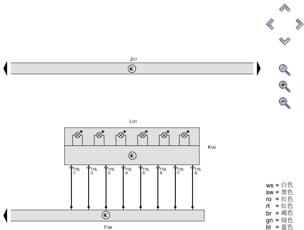
**Tiptronic 开关, 自动变速箱控制单元, 选档杆位置 P/N 指示灯, 排档杆档位指示照明灯**
